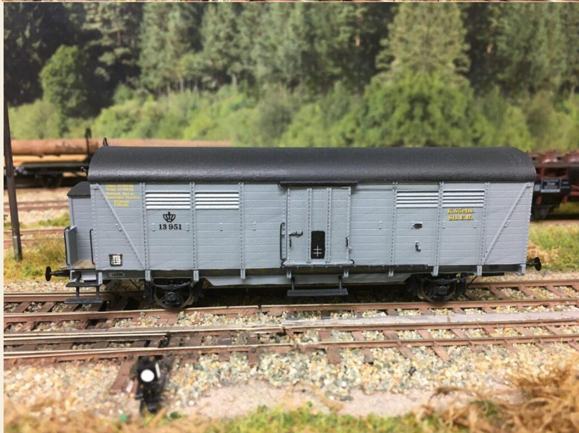
Vierachsiger Wagen für den Transport von flüssiger Kohlensäure der Fa. C.G. Rommenhölle
